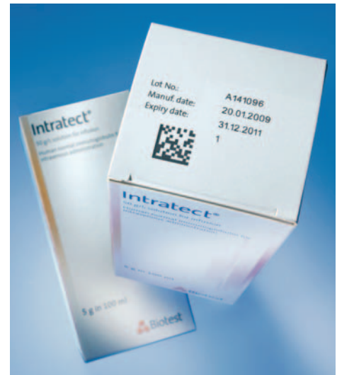
Der Serialisierungsdruck auf einer Pharma-Umverpackung.
